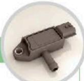
最准确的技术就是微机电系统(MEMS)。森萨塔科技开发出了基于MEMS的DPS,能满足排气工作环境的要求。森萨塔科技的专利技术能帮助OEM厂商提高DPF再生过程中的压差变化的监测精度,并避免过滤器堵塞。
